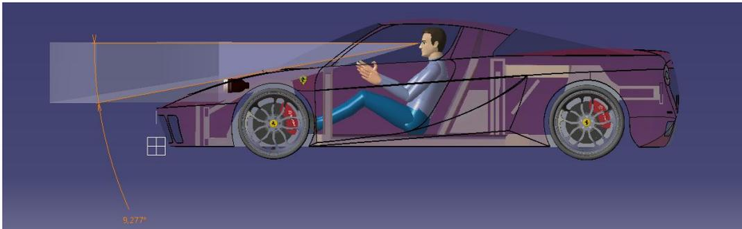
Figura 11: Angolo di visibilità verticale
