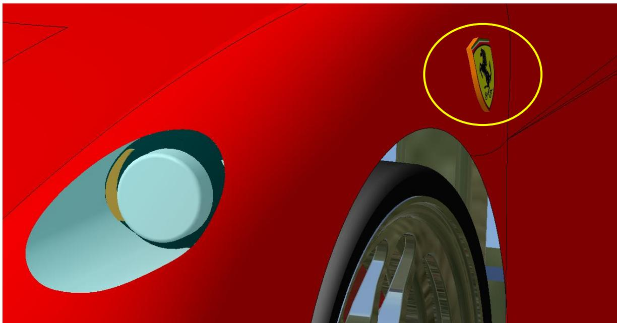
Figura 66: Dettaglio degli indicatori laterali di direzione. Sono stati posizionati sotto gli scudetti Ferrari posti sul passaruota
