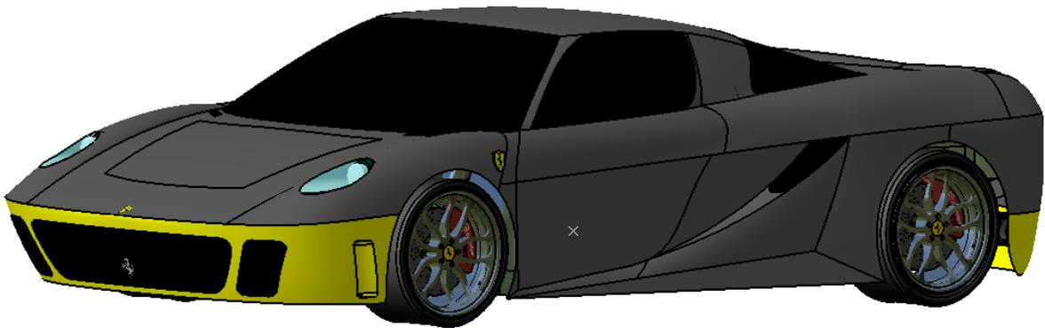
Figure 60 e 61: Paraurti anteriore e posteriore (colore giallo)
