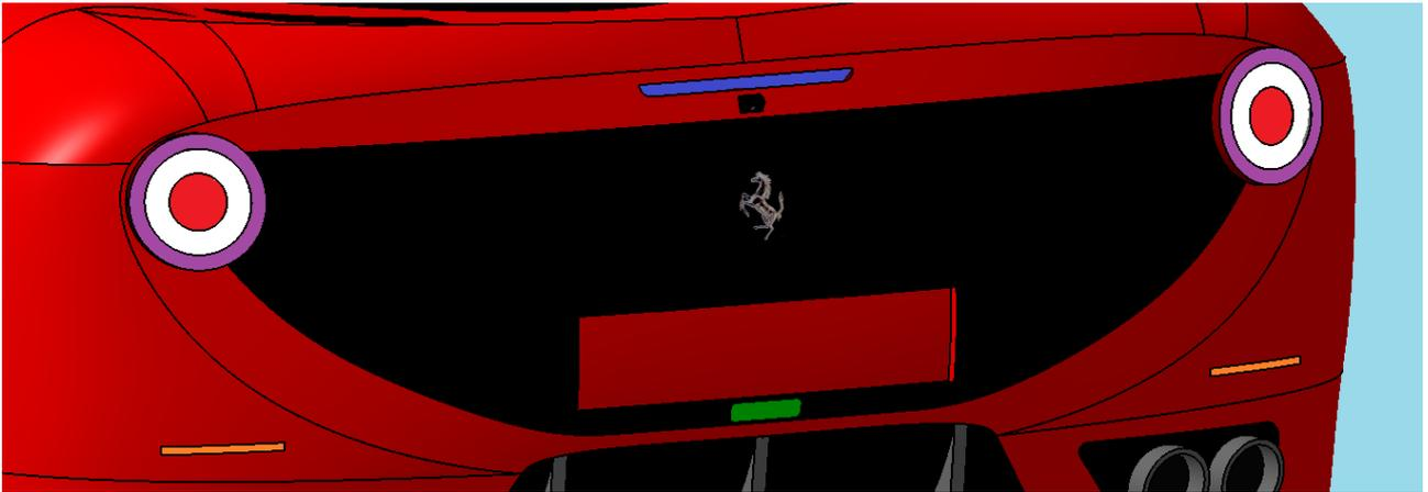
Figura 69: Fanaleria posteriore. Per chiarificarne il funzionamento si è deciso di colorare in rosso gli indicatori direzionali posteriori; in viola le luci di posizione che, aumentando d'intensità, fungono anche da luci di arresto; in verde il retronebbia; in bianco le luci per la retromarcia; in blu la luce di arresto supplementare; in arancione i catadiottri.
